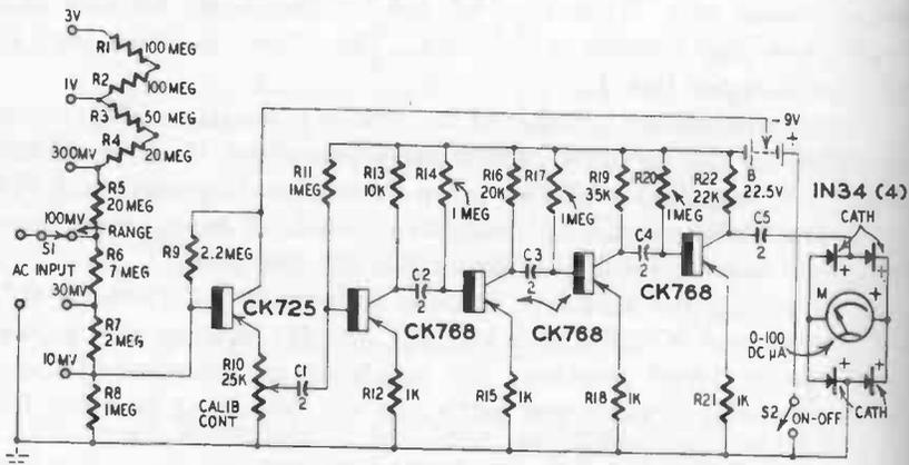
Fig. 907. Audio voltmeter-millivoltmeter.
