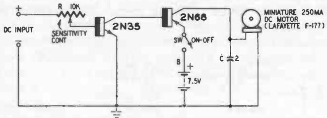
Fig. 813. Miniature-motor control.
