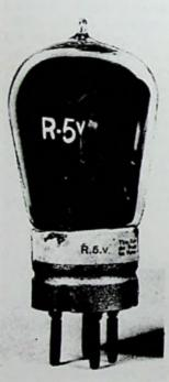
Fig. 18-25. Marconi-Osram R5V valve.
