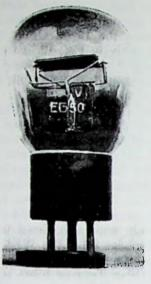
Fig. 22-10. Ostar EG50 110-volt rectifier tube.
