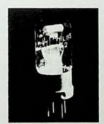
Fig. 20-2. Philips D2 tube.
